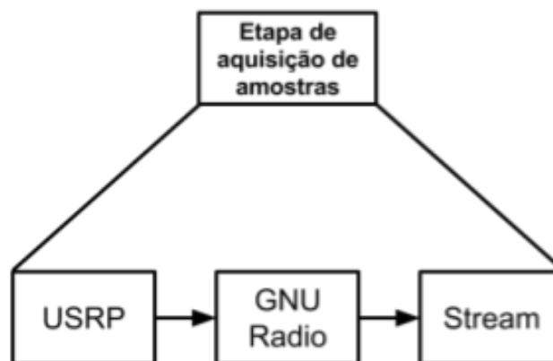
Figura 11 – Diagrama de blocos ampliado da etapa de aquisição de amostras.
