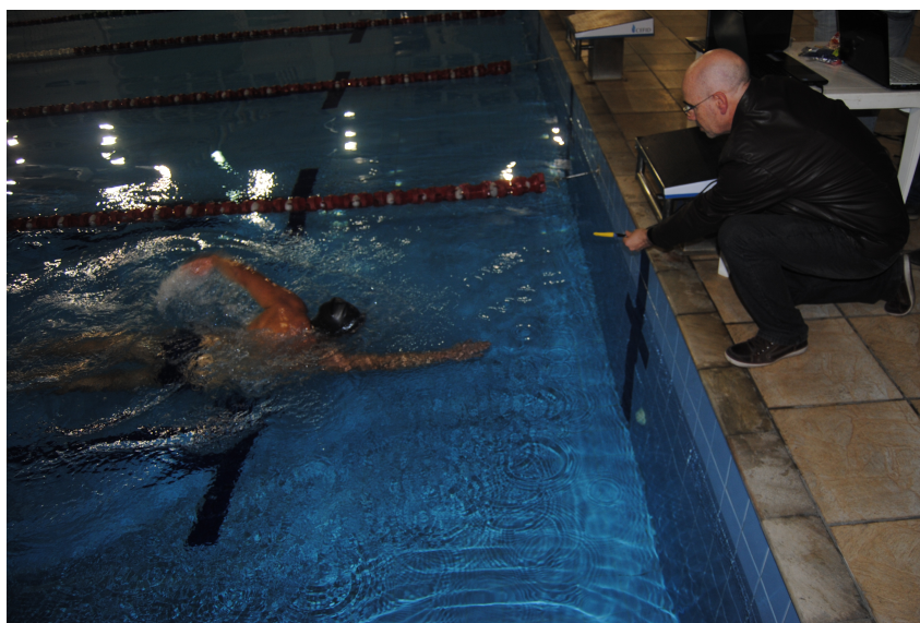
Figura 4.2: Foto exibindo o treino, com potência de -20dBm e a tag na touca.
