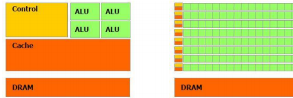
Figura 5 – Diferença entre arquitetura CPU e GPU. Fonte: (BREDER, 2016)
