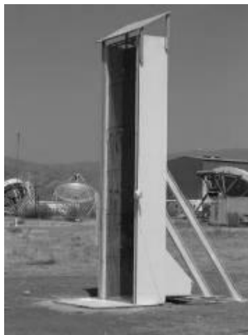
Figura 21. Chaminé solar experimental com inercia térmica instalada no Laboratório de Ensaios de Componentes de Edificação (PSA, Almería) para caracterização energética destes sistemas.
