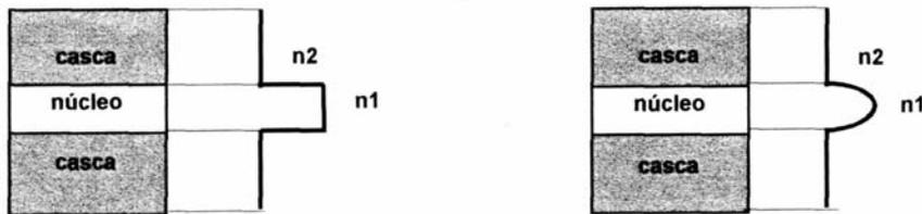
Figura 3-2: Perfis de índices de refração **degrau** e **gradual**.
