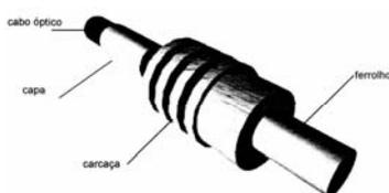
Existem vários tipos de conectores ópticos, sendo cada qual para uma utilização específica. Independente da forma de fixação, podemos dizer que um conector óptico básico é formado por: ferrolho, carcaça e capa conforme figura:
