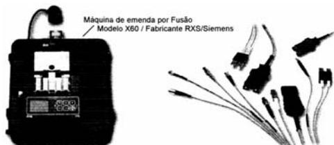
Devido à pequena seção transversal das fibras, é extremamente difícil fazer uma emenda perfeita. As emendas podem ser feitas por fusão ou conexão.
