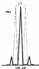
O Chirp ou também conhecido como ruído de gorgueio do laser semiconductor, é associado ao alargamento da linha de emissão do laser quando modulado diretamente. Variações na corrente de injeção do laser causam uma mudança na densidade de portadores do material semiconductor, alterando o **índice de refração** do dispositivo.
