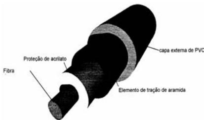
Os **cordões monofibra** são cordões ópticos multimodo ou monomodo, tipo **tight**. As fibras têm revestimento primário em acrílate e revestimento secundário em nylon. Sobre o revestimento secundário são colocados elementos de tração de fios sintéticos de aramida. Os cordões são reunidos e revestidos por uma camada de material PVC colorido não propagante a chama.
