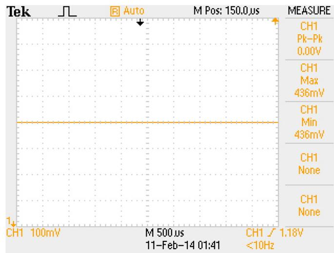
Figura 4.20: Medição do consumo de energia com o módulo de rádio desativado
