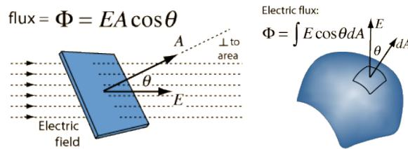
Figura 2 - Fluxo elétrico: intensidade de campo elétrico na direção perpendicular à superfície considerada [3].
