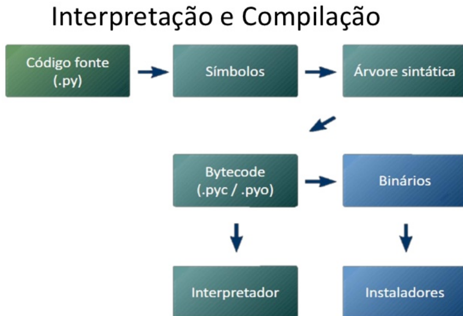
Figura 2.12: Diagrama de Bloco Interpretação e compilação PYTHON
