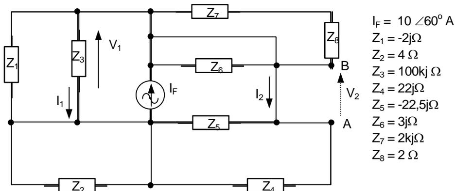
18. Para os circuitos abaixo, determine o valor da **impedância Z** que irá produzir as tensões e correntes indicadas no circuito.
