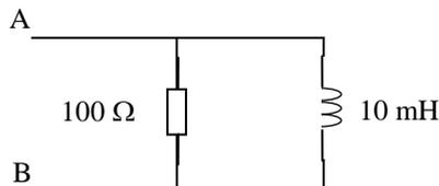
4. Determine a impedância equivalente vista dos pontos A e B considerando as velocidades angulares abaixo:
