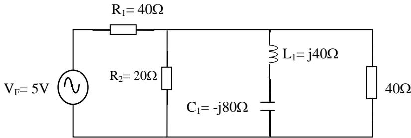
8. Dado o circuito abaixo determinar: **Zeq**. E a tensão entre os pontos A e B
