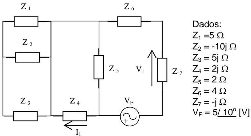
22. No circuito abaixo, determine o valor da Corrente  $I_1$  e da Tensão  $V_1$ .
