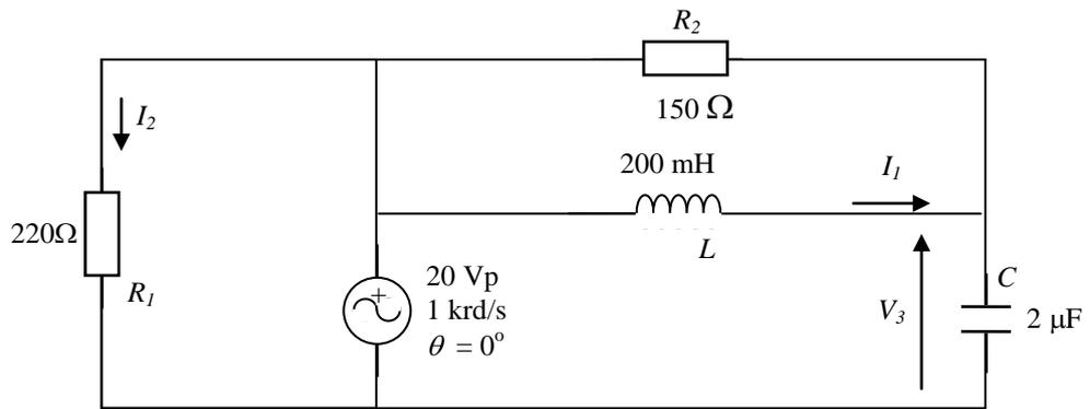
17. Dado o circuito abaixo determine as **correntes** e as **tensões** indicadas no esquema.
