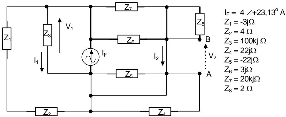
21. No circuito abaixo, determine o valor da Corrente  $I_1$  e da Tensão  $V_1$ . Depois calcule o valor numérico do fasor tensão  $V_1$  e da tensão  $v_1(t)$ . A frequência da fonte é de 100 rd/s.
