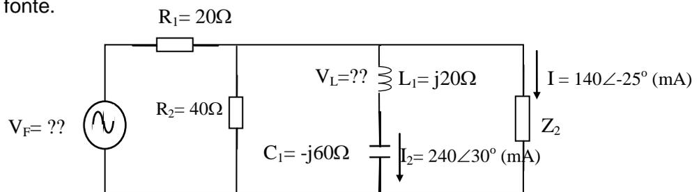
12. Dado o circuito, e sabendo que a tensão  $V_1$  é de  $6 \angle 15,95^\circ$  (V), a frequência é de 200 Hz. Calcule o valor da impedância  $Z$ . Determine o tipo de associação que corresponde à impedância  $Z$  (RL, RC, L, C ou R). Calcule o **valor numérico** do(s) componente(s) da associação equivalente à impedância  $Z$ .
