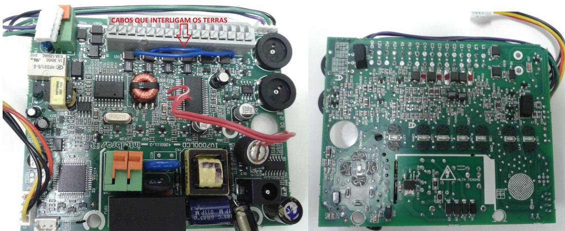
Figura 5.4: Placa alterada (vista dos dois lados da placa).
