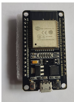
Figura 6 – Kit de desenvolvimento ESP32-DevKitC
