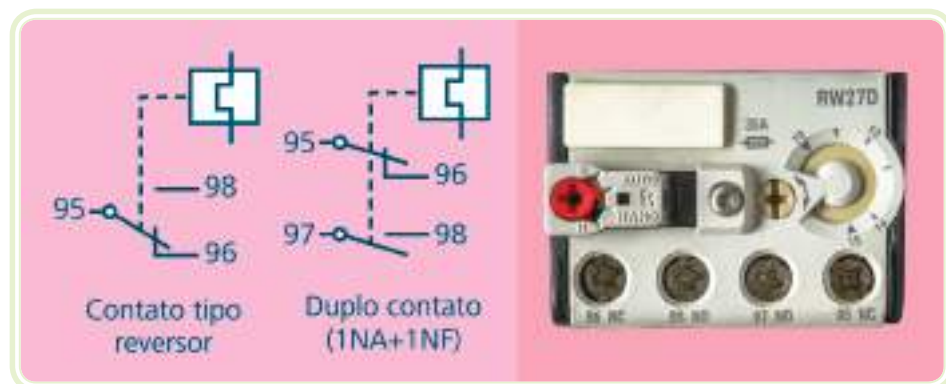
Figura 8.11: Contatos auxiliares do relé de sobrecarga
