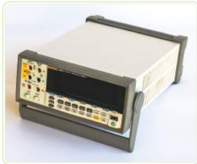
Figura 5.10: Multímetro de bancada
