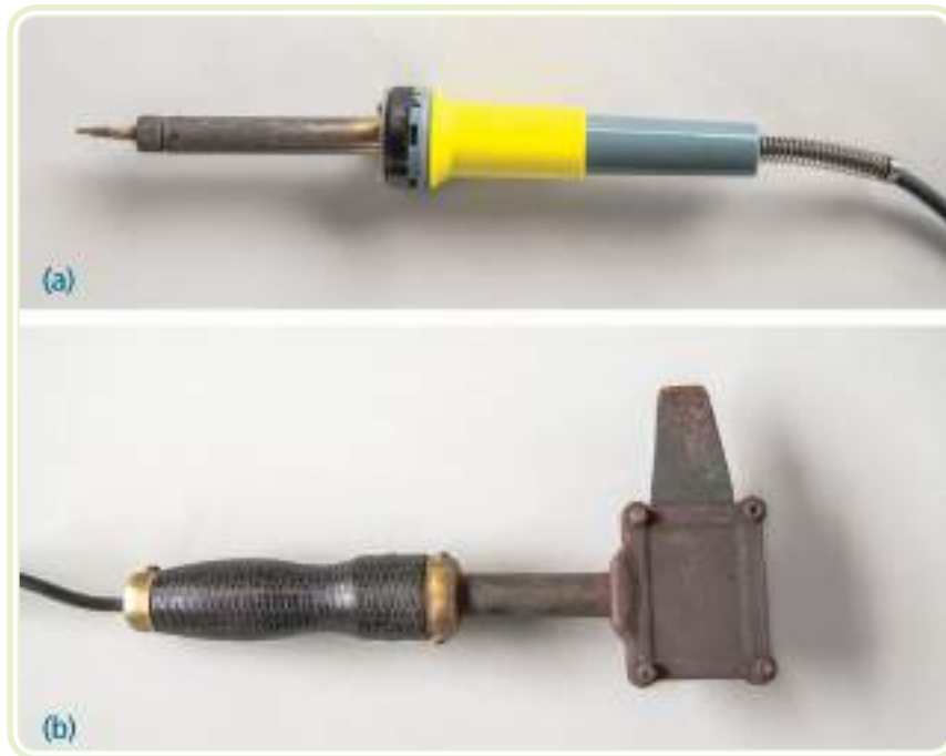
Figura 6.10: Diferentes tamanhos e formas de ponta de ferros de solda elétricos de menor potência (a) e de maior potência (b)
