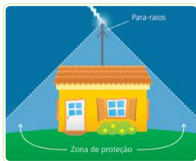
Figura 1.7: Aplicação de para-raios
