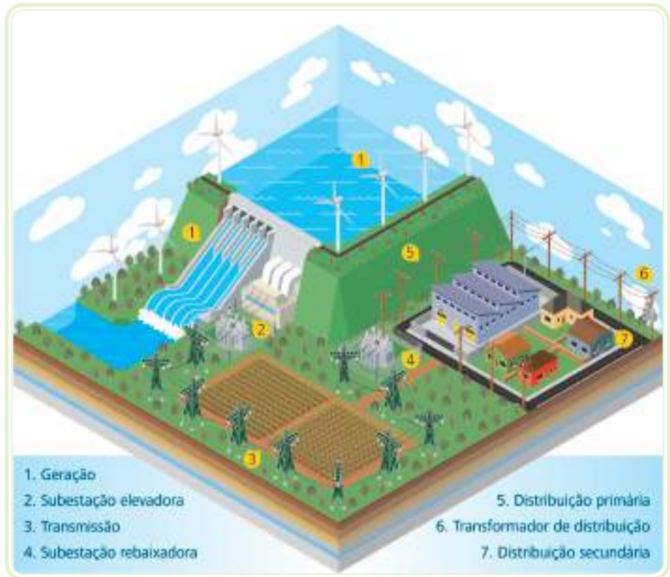
Figura 4.5: Etapas do sistema elétrico
