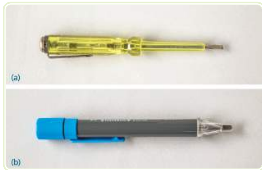
Figura 6.11: Canetas de teste de tensão de contato (a) e por campo elétrico (b) Fonte: CTISM
