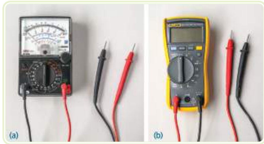
Figura 5.9: Multímetros portáteis analógico (a) e digital (b)
