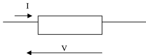
Esse fenômeno da transformação de energia elétrica em energia térmica, no resistor, é conhecido por Efeito Joule e tem importantes aplicações práticas, como lâmpada incandescente e chuveiro elétrico.
