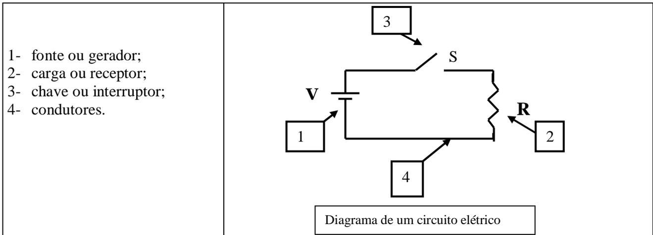
*Outros elementos podem fazer parte de um circuito elétrico, tais como: dispositivos de proteção ( fusível, disjutor, ....), de medição ( amperímetro, voltímetro,multímetro .... ), etc.*
