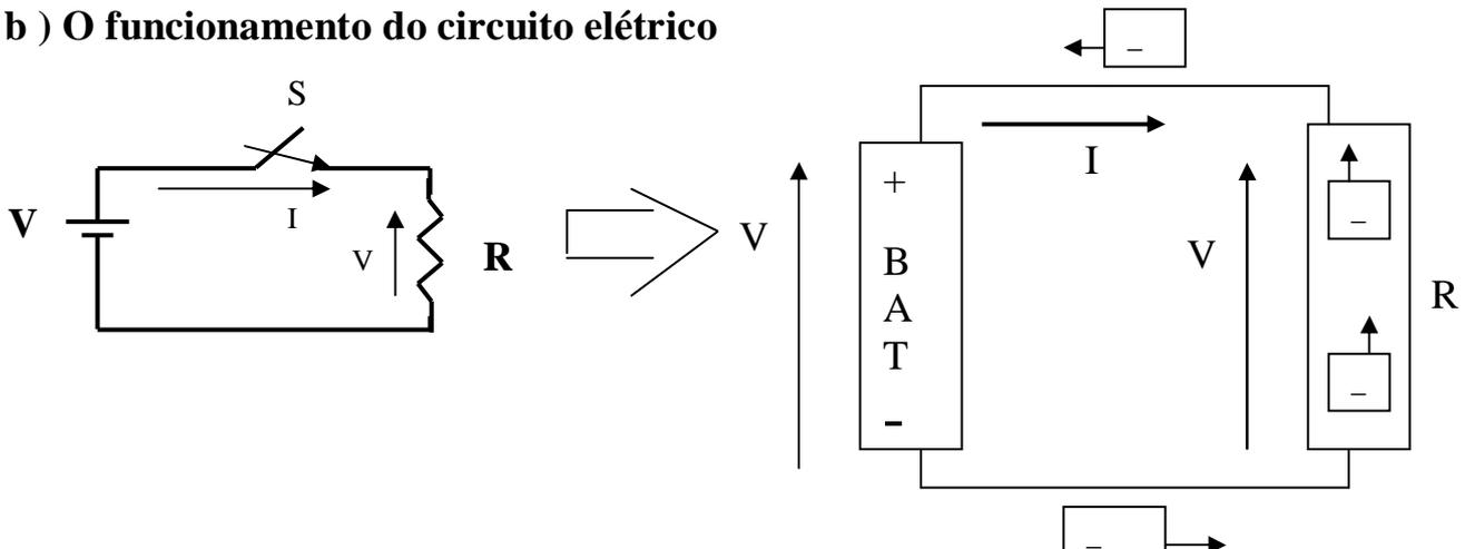
Ao se fechar a chave “S”, por ação da tensão elétrica entre os pólos da bateria, elétrons livres do condutor/resistor são levados ao pólo positivo da fonte. Na mesma taxa elétrons são fornecidos pelo pólo negativo, fechando o ciclo. A repetição sucessiva deste ciclo forma a corrente contínua.
