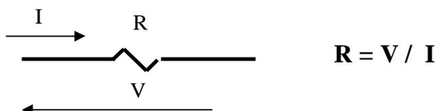
Por ex.: Se a queda for de 12 V e a corrente de 2A, a resistência será  $12 / 2 = 6 \Omega$ .
