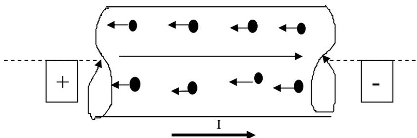
(\*)A bem da verdade, esse “movimento ordenado” é uma simplificação, pois na realidade a movimentação dos elétrons é acelerada pela ação de um campo elétrico e marcada por choques entre si e contra os átomos do próprio material, resultando numa arrastada progressão, no sentido contrário ao campo, no sentido do polo positivo da fonte.
