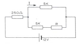
12) Calcule o valor de  $R_1$  para a resistência equivalente entre A e B se já de 3 k $\Omega$ .
