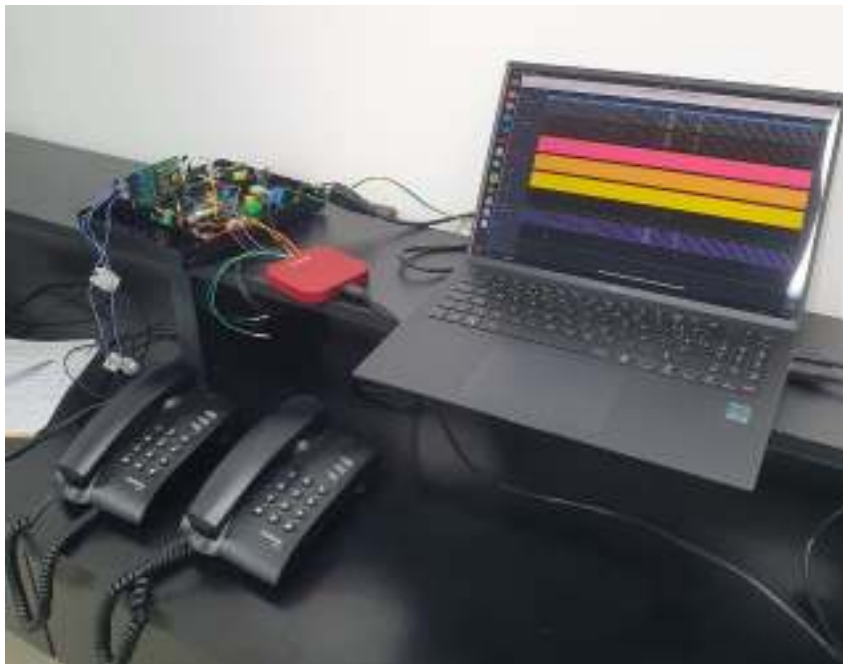
Figura 15 – Cenário montado para análise do funcionamento da placa de ramal
