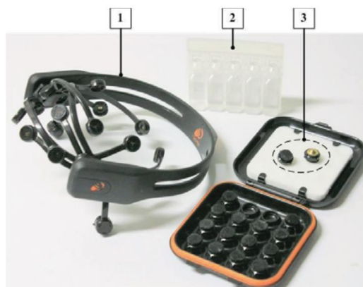
Figura 5: Neuroheadset com acessórios: 1 - Emotiv EPOC ® , 2 - solução salina, 3 – eletrodos (HOLEWA; NAWROCKA,2014)
