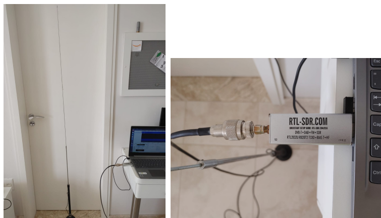
Figura 7 – Antena à esquerda; Receptor RTL2832U e adaptador à direita
