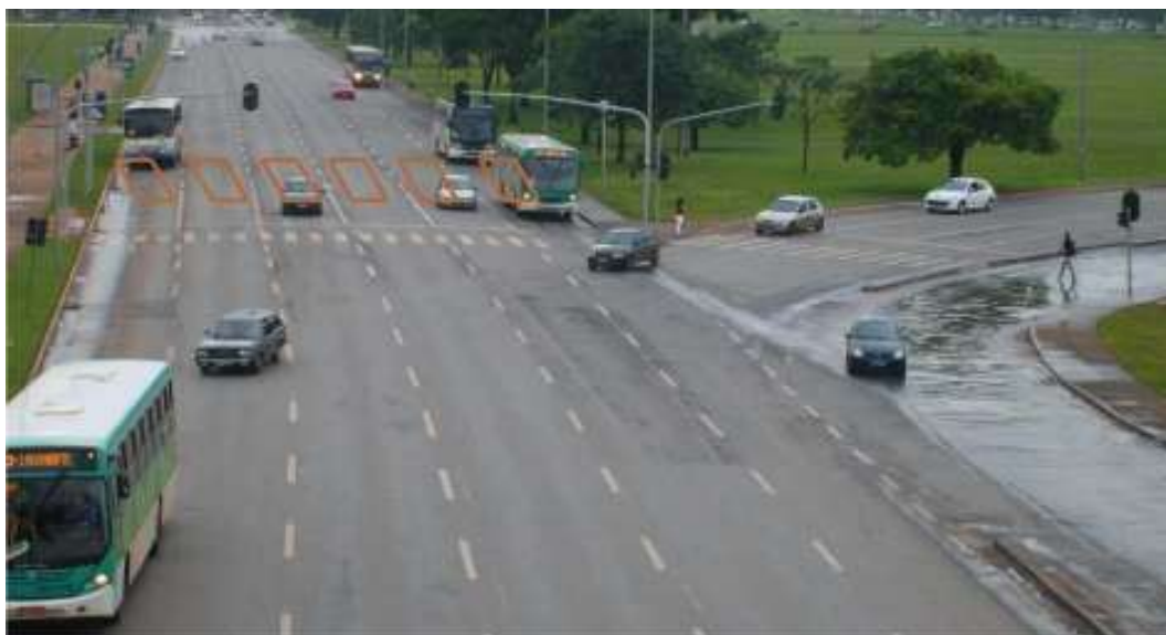
Figura 2.8: Representação de imagem de vídeo com zonas de detecção configuradas na tela do monitor
