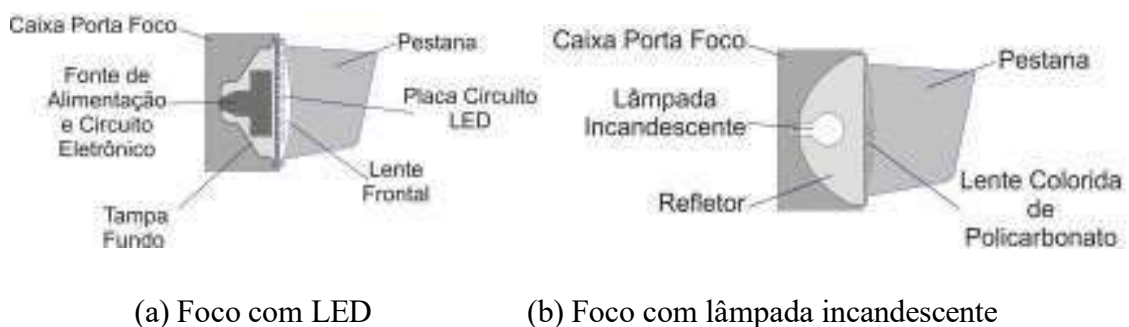
Figura 2.1: Elementos constituintes dos focos semafóricos
