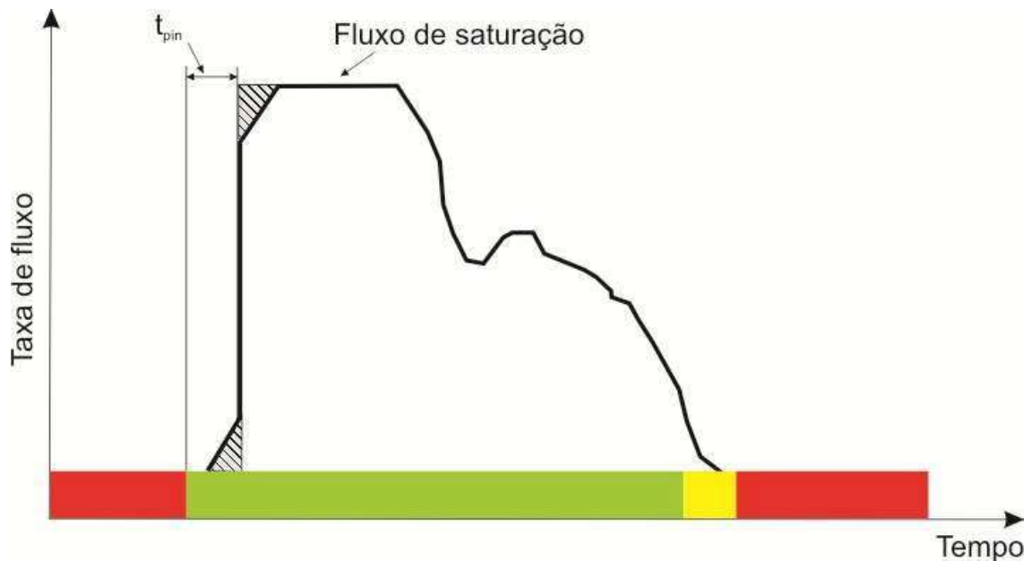
Figura 6.5: Fluxo de saturação e tempo perdido inicial em estágio não saturado
