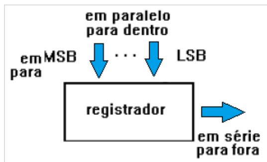
Figura 6 - Diagrama em blocos para o registrador entrada paralela e saída serial.
