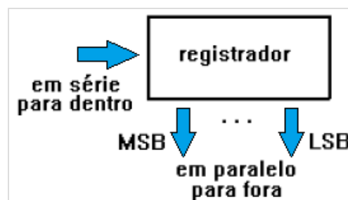
Figura 5 - Diagrama em blocos para o registrador entrada série com saída paralela.
