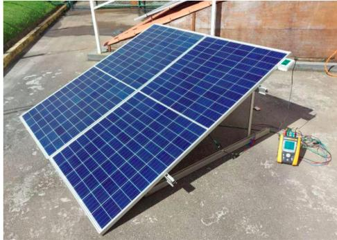
(a) Medição dos módulos usando PV-Check
