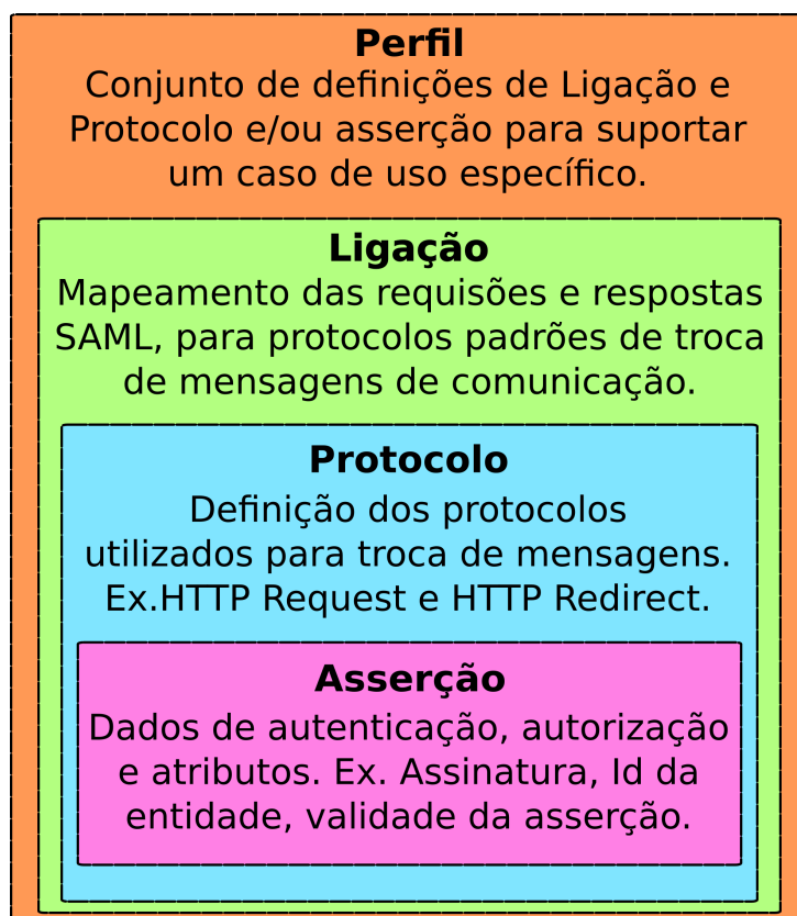
Figura 2.2: Pilha de componentes SAML. Fonte: (OASIS, 2008)
