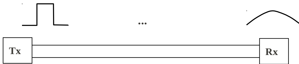
Figura 21: Efeito da dispersão em um pulso que percorreu a linha de transmissão
