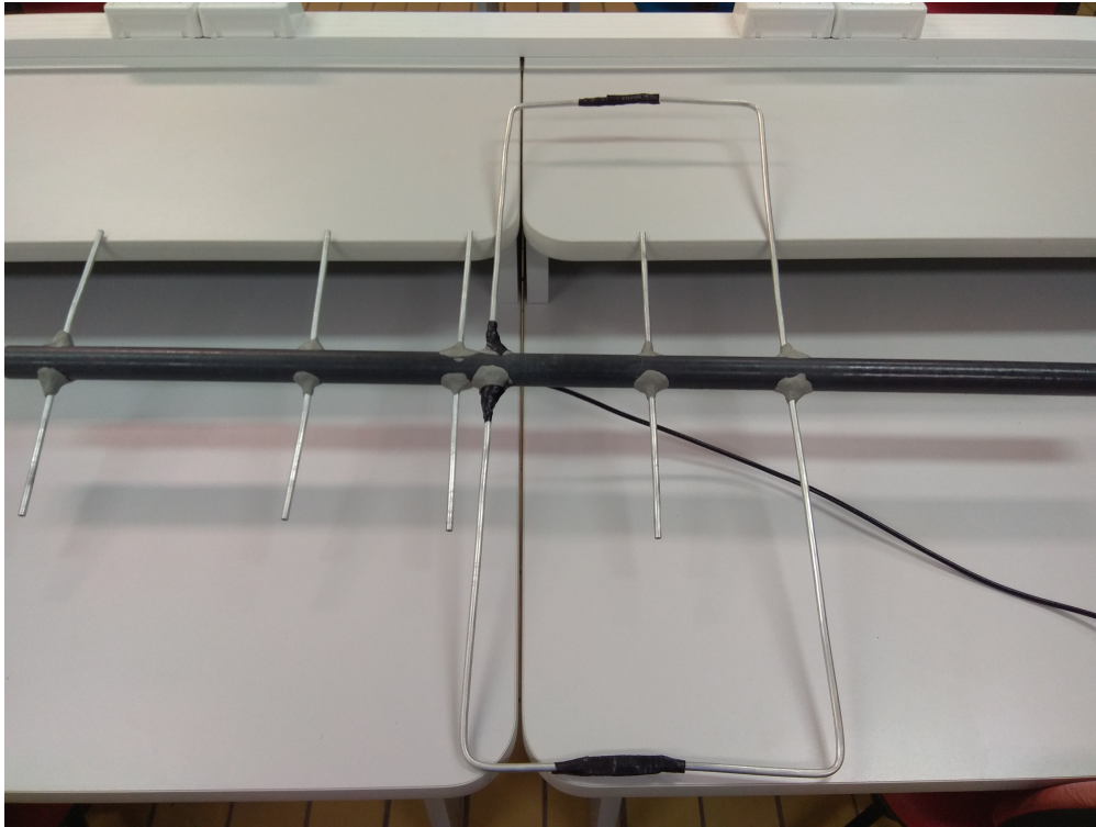
Figura 34 – MoxonZBZ construída Elaborada pelo autor
