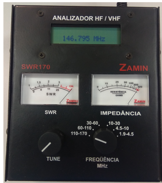
Figura 11 – Analisador de impedância Zamin SWR 170
