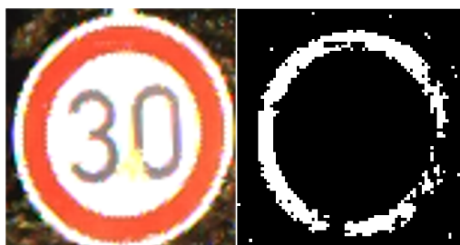
Figura 2.6: Limiarização de uma imagem colorida (a) Imagem original; (b) Imagem limiarizada.
