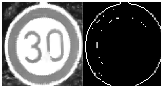
Figura 2.8: Método de Sobel em uma imagem em escala de cinza (a) Imagem original; (b) Imagem de bordas.
