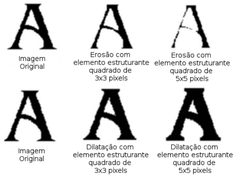
Figura 2.7: Processo de erosão na primeira linha e dilatação na segunda linha.
