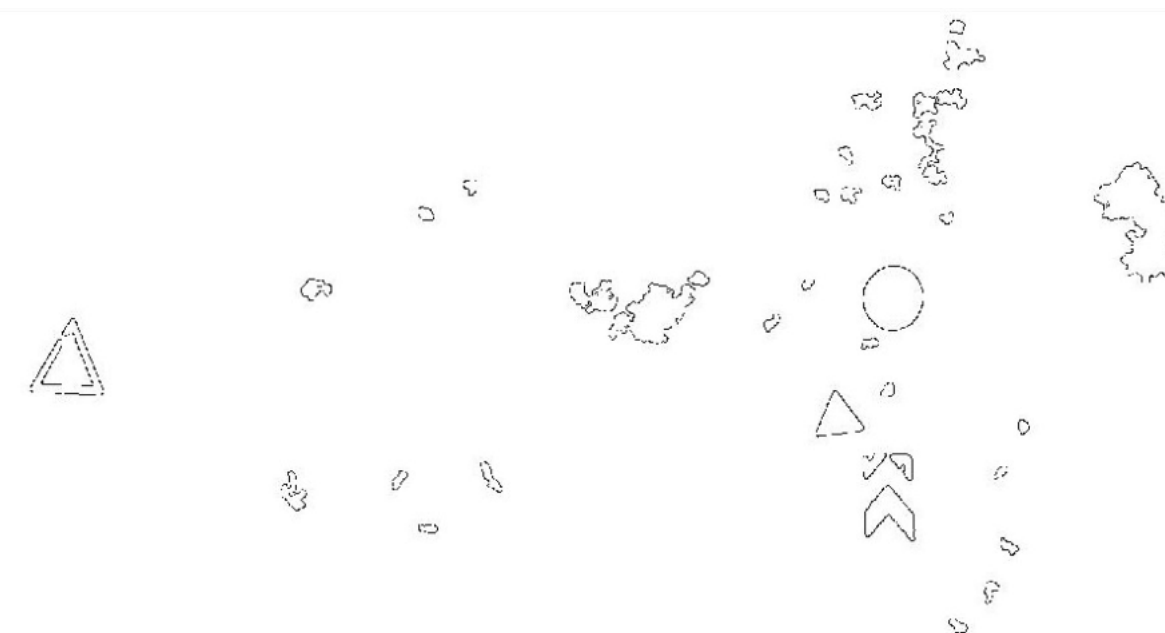
Figura 3.14: Aplicação do método de Canny para detecção de bordas.
