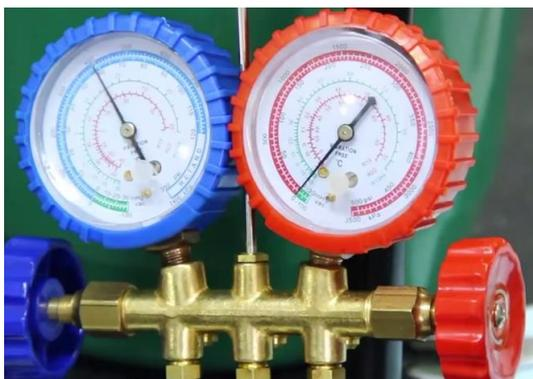
Figura 2.11– Ilustração de um manifold típico.
