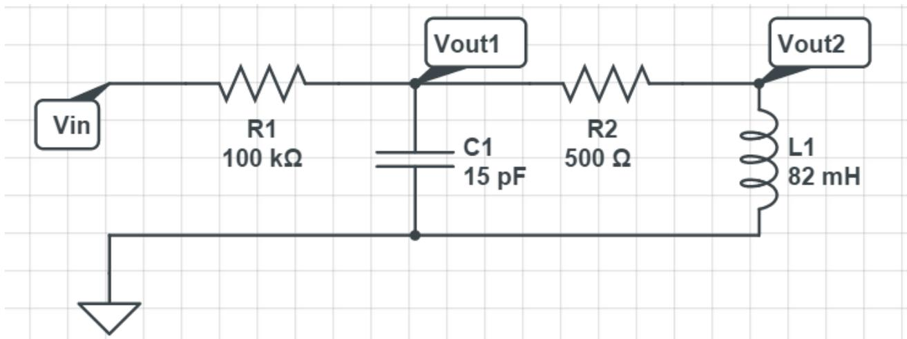
**Figura 6 – Circuito equivalente da cascata dos dois filtros**
