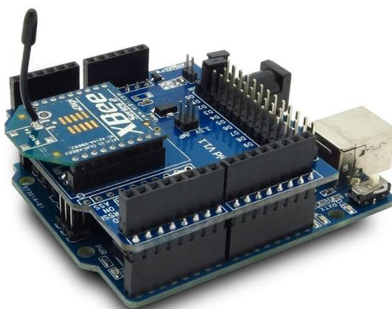
Figura 4.7: Arduíno com a *shield* e o módulo XBee acoplados.
