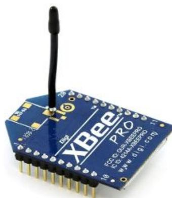
Figura 2.10: Módulo XBee.
