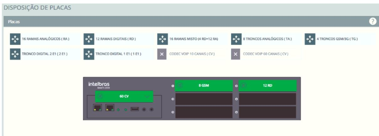
Figura 90 – Configuração da disposição de placa com Codec
