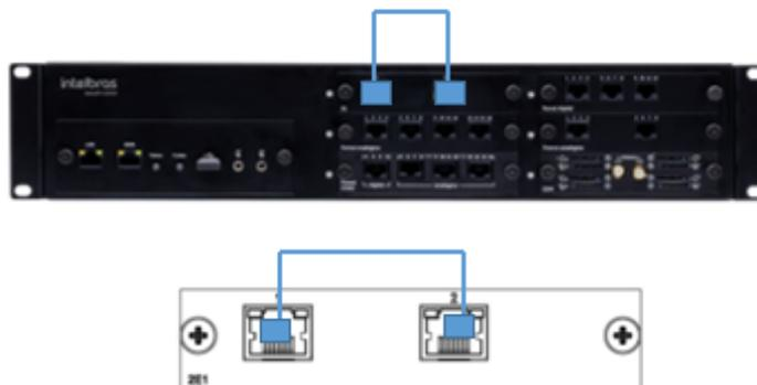
Figura 67 – Interligação entre o link 1 e link 2 da placa tronco 2 E1
