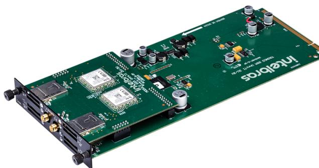
Figura 29 – Placa Tronco GSM com placa expansão instalada
