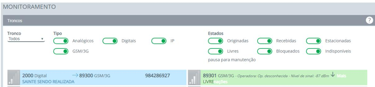
Figura 58 – Tela de monitoramento do tronco GSM 89300 ao originar uma ligação
