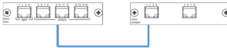
Figura 40 – Interligação entre ramal analógico e tronco analógico
