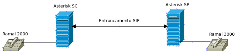
Figura 2.12: Exemplo de utilização de entroncamento SIP
