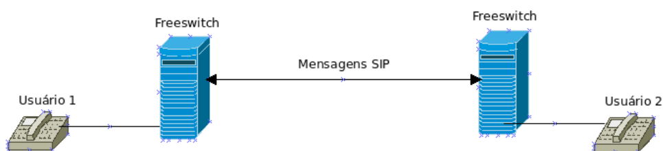
Figura 2.13: Exemplo de uma configuração VoIP com FreeSwitch e mensagens SIP
