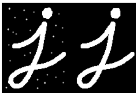
Figura 11 – Efeitos do processo de abertura Fonte: inf.ufpr.br
