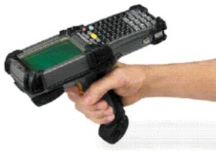
Figura 2.16: Exemplo de um leitor (RFID e código de barras) portátil com antena integrada. FONTE: (DUARTE, 2005)
