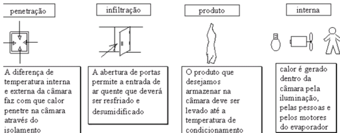
Figura 2.5 – Parcelas de carga térmica
